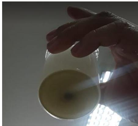
**Nota:** La Figura 9 muestra cómo se precipita la zeolita al no tener una buena solubilidad en agua. **Fuente:**(Pavón 2022).
