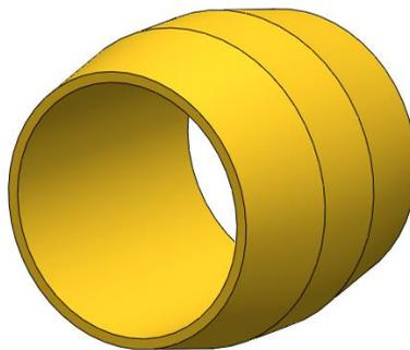
**Refuerzo interior.** Es un componente adicional Figura 48, se lo utiliza para fortalecer la unión entre una manguera y un racor, se lo coloca dentro de la manguera, generalmente en la zona cercana a la unión con el racor, antes de realizar la conexión. Su función principal es evitar la deformación excesiva o el colapso de la manguera cuando se aplica presión o se somete a fuerzas mecánicas.
