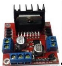
*Fig. 3.3: Controlador de motores [16]*
