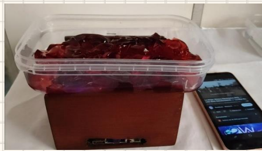
Figura 6. Propagación del sonido en la gelatina
