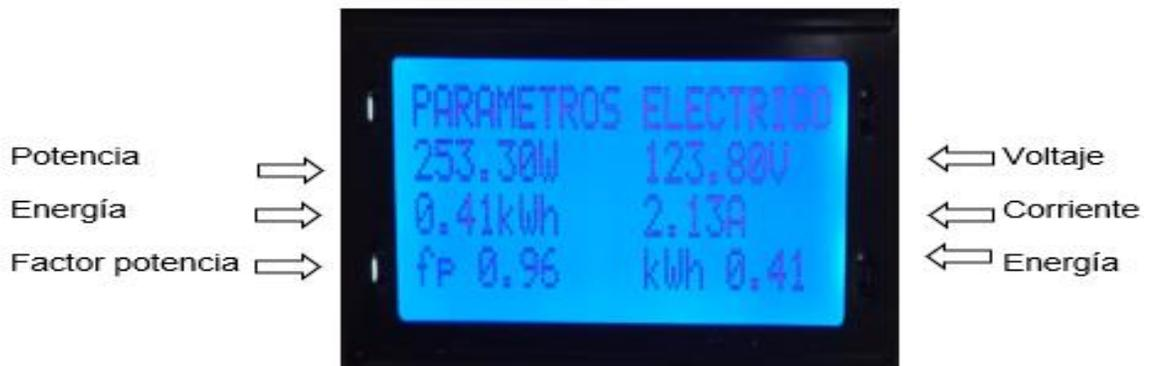
*Nota.* El gráfico muestra valores de corriente, voltaje, potencia, energía y factor de potencia
