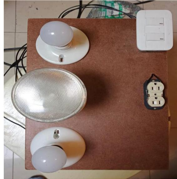
**Anexo 8.** Pruebas realizadas de corriente, voltaje, potencia y factor de potencia cada tres minutos
