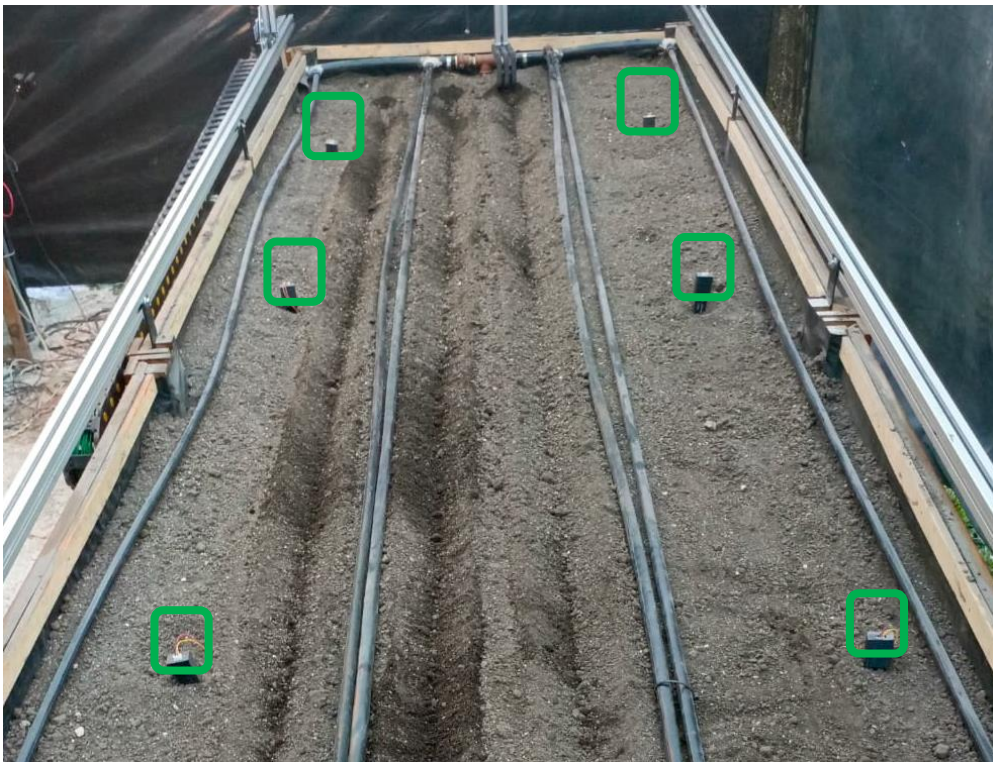
Figura 55 Ubicación de los sensores de humedad en la mesa de cultivo
