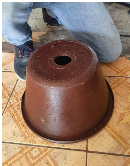
FIGURA 32 ADAPTACIÓN DE RECIPIENTE PARA LA RECOLECCIÓN DE AGUA EN LA SALIDA DEL GENERADOR (FUENTE: AUTOR)
