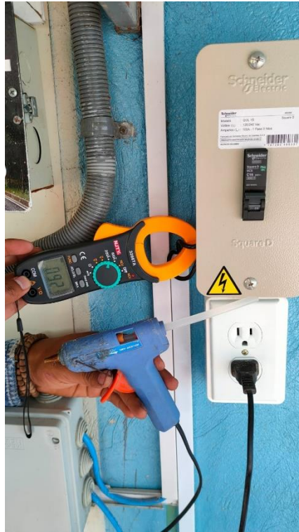
FIGURA 44 CORRIENTE ELÉCTRICA CON CARGA DE 12W - 0.092A (FUENTE: AUTOR)
