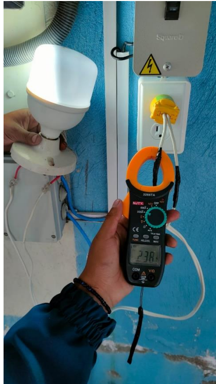
FIGURA 42 CORRIENTE ELÉCTRICA CON CARGA DE 40W - 0.238A (FUENTE: AUTOR)
