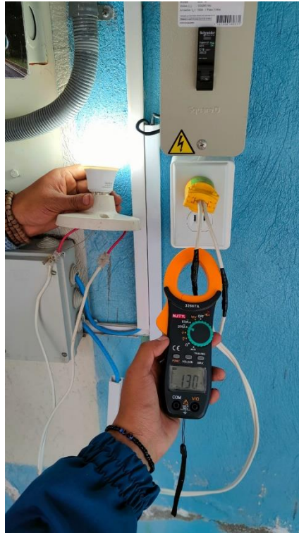
FIGURA 46 CORRIENTE ELÉCTRICA CON CARGA DE 8.5W - 0.130A (FUENTE: AUTOR)
