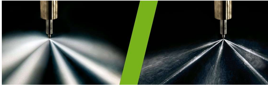
Figura 17.1 Tobera de inyector en buen y mal estado
