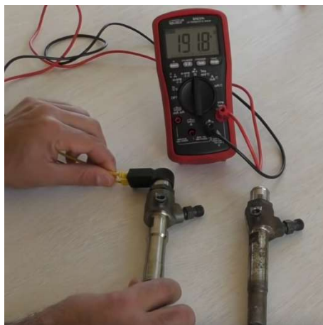
Figura 27.2 Comprobación de resistencia en inyector Piezo Eléctrico
