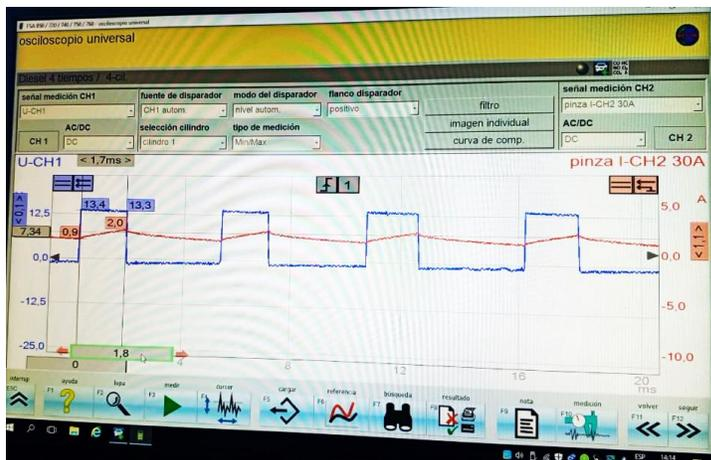
*Figura 22.2 Señal PWM válvula reguladora*
