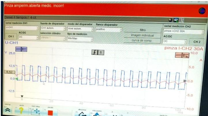
**Figura 20.2** Señal PWM válvula reguladora
