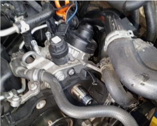
**Figura 17.2** Bomba CP4 con montaje en vehículo
