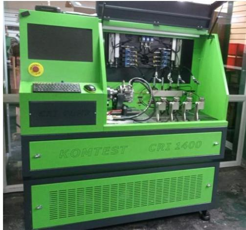
**Figura 13.2** Banco de Pruebas de Inyectores
