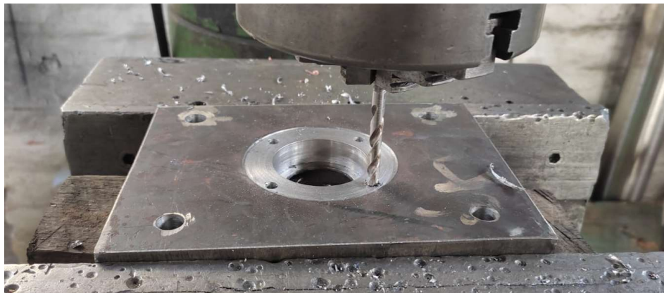
Perforación de agujeros en placa de sujeción
