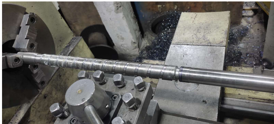
Figura 37 Mecanizado del tornillo sin fin
