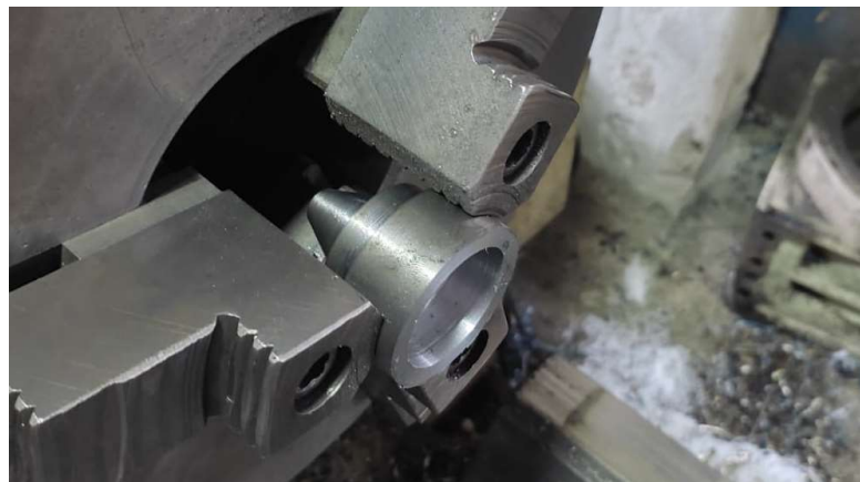
Figura 41 Mecanizado cabezal inyector
