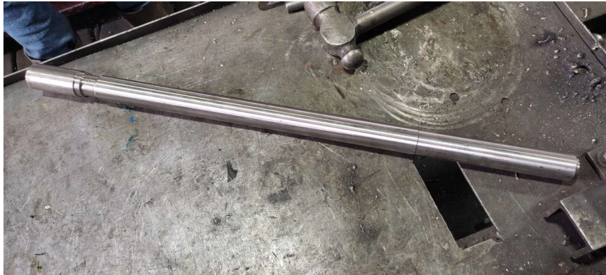
Figura 36 Husillo de inyección – AISI 304
