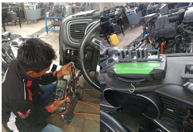
Figura 2.5 Conexión del osciloscopio, scanner y multímetro
