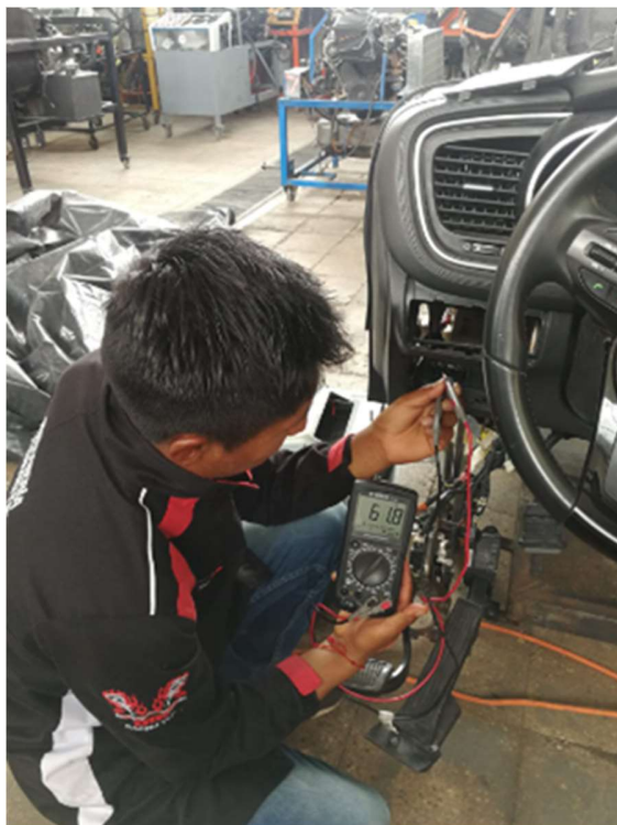
Figura 2.6 Prueba de impedancia en la red CAN Bus
