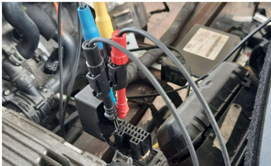
Figura 2.7 Pines 6 y 14 del puerto OBD DIAGNOSTIC KIA
