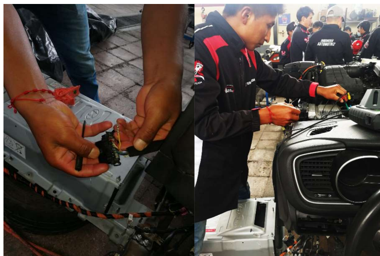
Figura 3.16 Retiro del pin 14 del puerto OBD II y conexión del osciloscopio al puerto
