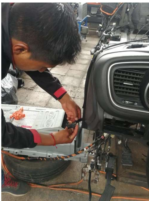
Figura 3.19 Retiro del pin 6 del puerto OBD II y en el puerto OBD DIAGNOSTIC KIA
