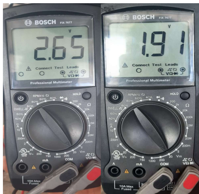
Figura 3.3 Valores de tensión CAN High y CAN Low
