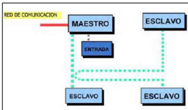
Figura 1.11 Configuración maestro esclavo
