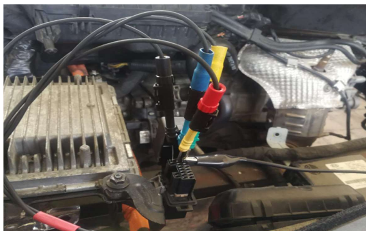
Figura 3.13 Enlace del pin14 del OBD DIAGNOSTIC KIA al polo positivo de la batería de 12
