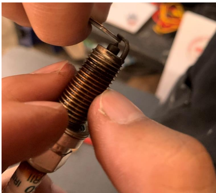
Figura 2.8 Medición de la calibración de las bujías (Elaboración propia)
