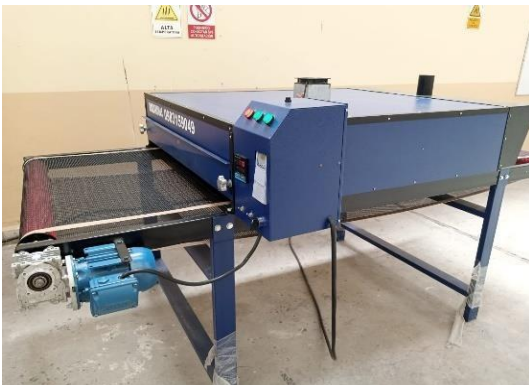
Túnel de secado
