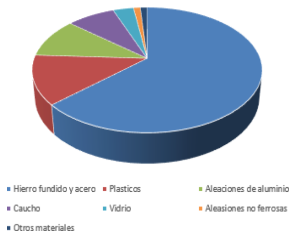
Figura 2.10 diagrama de los porcentajes de los principales materiales y aleaciones que son empleados en los componentes o piezas de un vehículo
