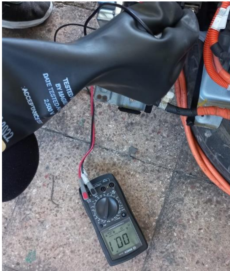
Figura 3.10 Continuidad del relé principal
