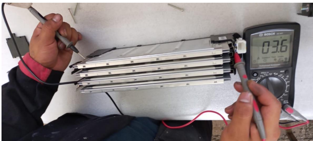
Figura 3.3 Medición de una celda de Ion de Litio
