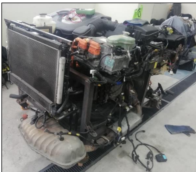
Figura 2.2 Banco de pruebas del KIA Óptima Híbrido
