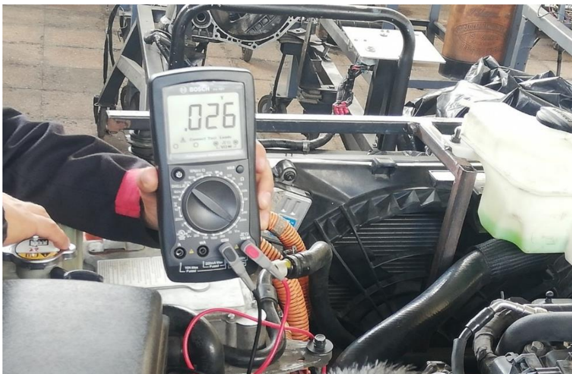
Figura 3.1 Medición del condensador del inversor
