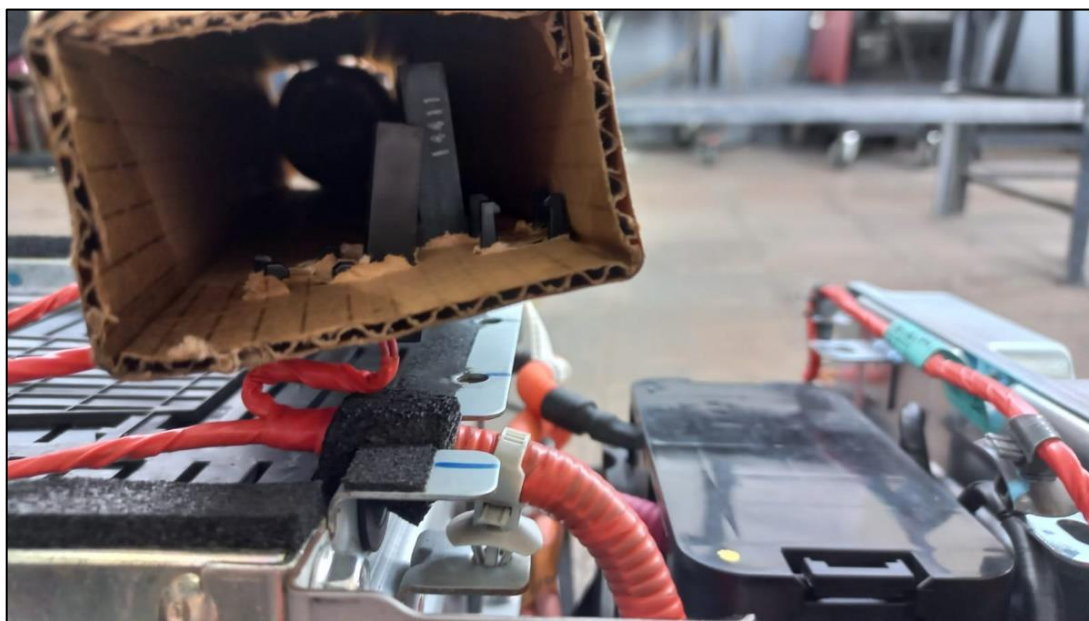
Figura 2.41 Aislamiento de los 2 sensores de temperatura
