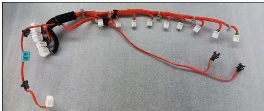
Figura 2.25 Mazo de cables de la BMS
