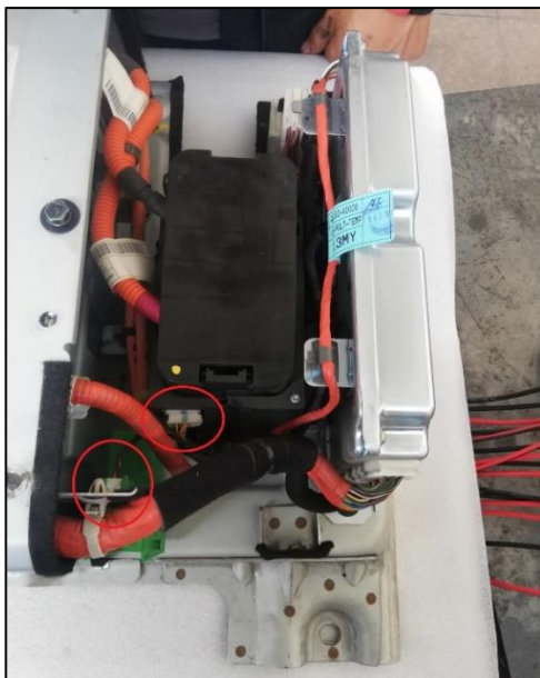
Figura 2.27 Conexiones del enchufe de seguridad
