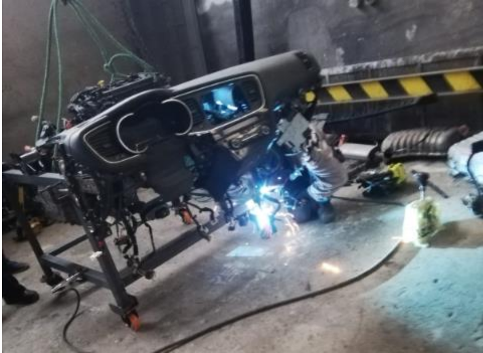
Figura A.I.5: Soldadura de la estructura.
