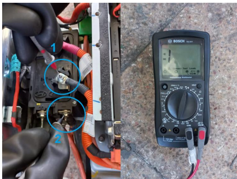
Figura 3.9 Continuidad del relé principal
