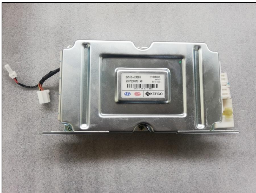
Figura 2.23 ECU BMS desarmada
