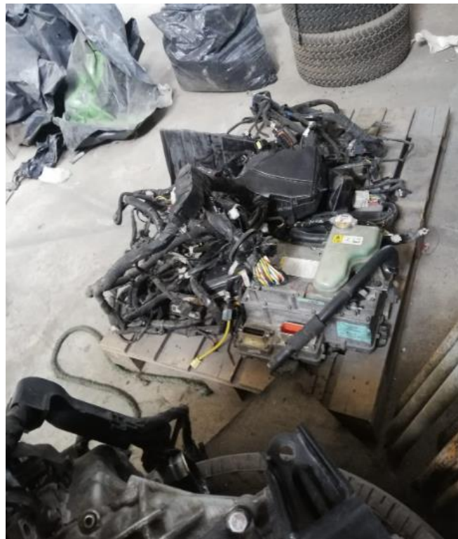
Figura A.I.4: Conjunto de cables de la maqueta.
