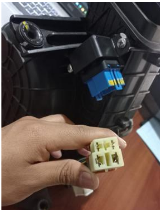
Figura A.III Socket del relé del ventilador
