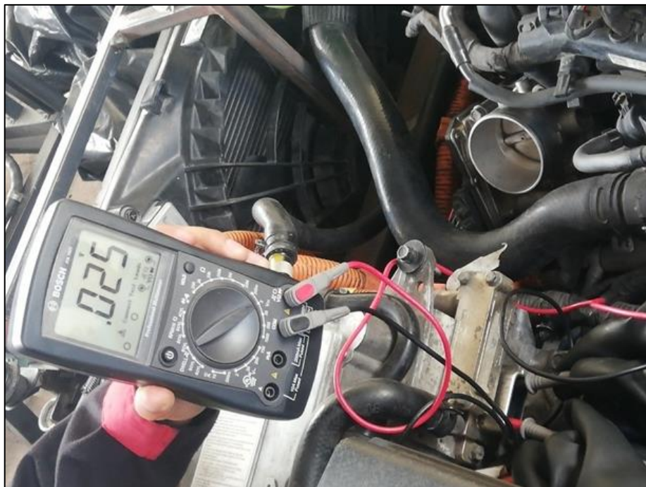
Figura 2.45 Medición de la tensión del condensador del inversor
