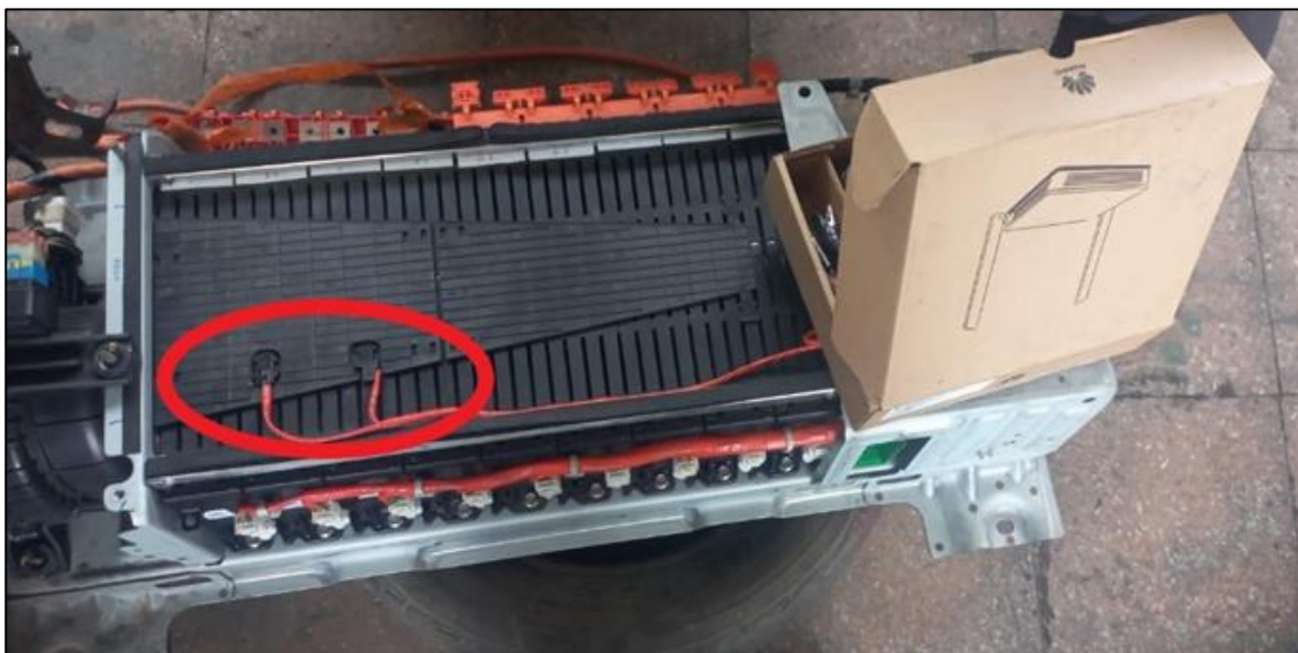
Figura 2.40 Desmontaje de los sensores de temperatura
