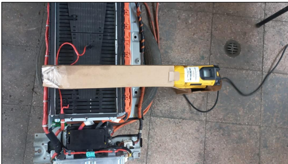
Figura 2.48 Inicio de la simulación con la pistola de calor
