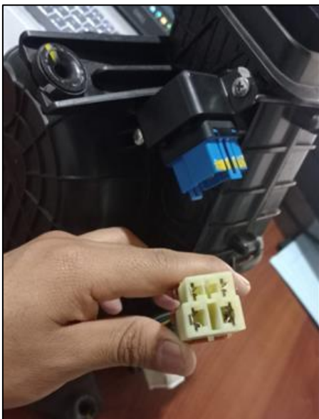
Figura 2.38 Socket del relé del ventilador
