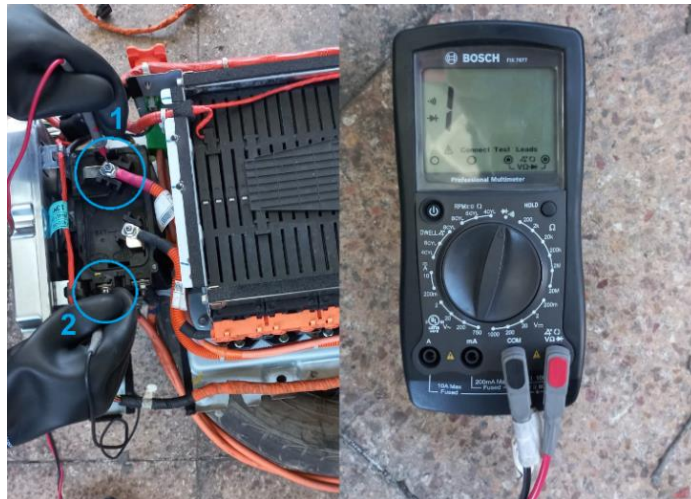
Figura 3.11 Continuidad del relé de precarga
