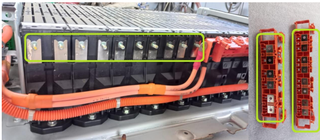
Figura A.III Terminales de los módulos
