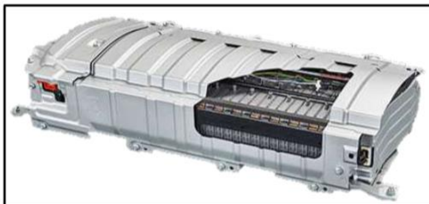
Figura 1.12 Batería de alta tensión Toyota
