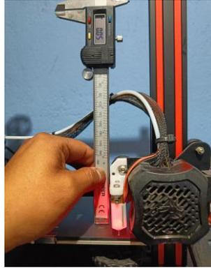
*Figura 4.3. Nivelación de cama con calibrador.*
