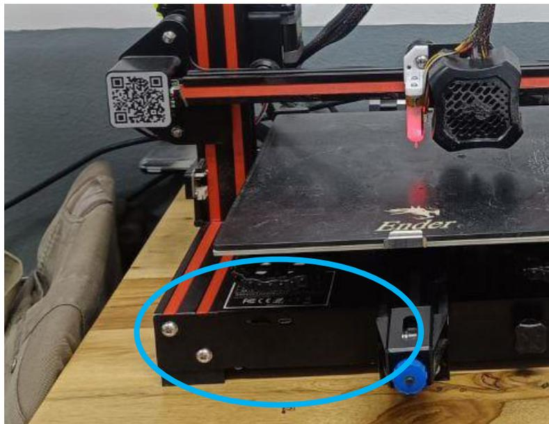
*Figura 3.4. Tapa de la tarjeta controladora*
