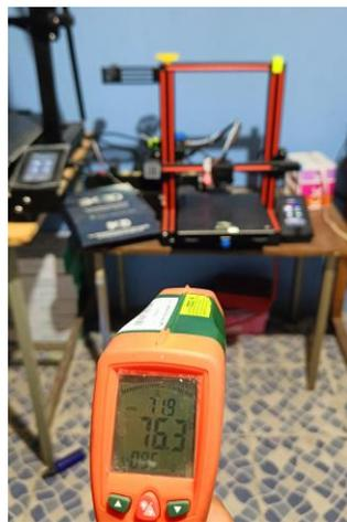
Figura 4.7. Temperatura medida sobre la cama de impresión por el termómetro infrarrojo.
