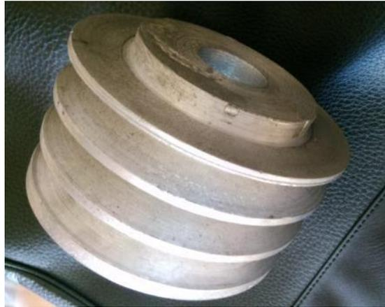
*Figura 2.3. Modelo fundido de polea [10].*
