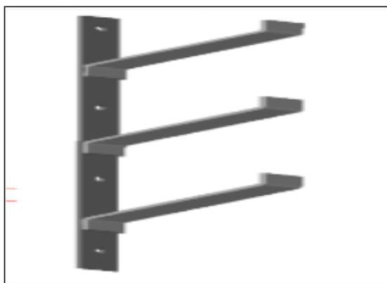
Figura 6 Soporte para conductores.
