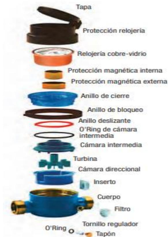
*Nota:* Componentes de un contador de chorro único, adaptado de Martínez, 2017.
