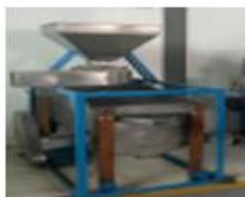
*Figura 9. Tamizadora-caranda vibratoria
