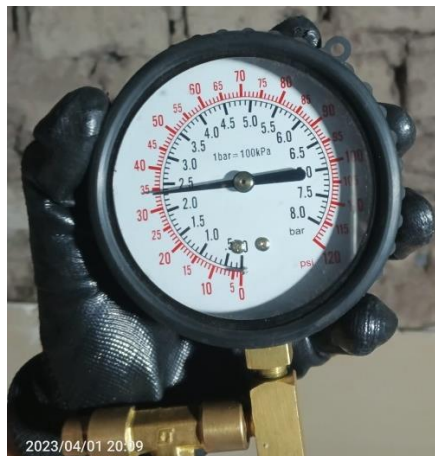
Figura 2. 14. Variación de presión de bomba de combustible
