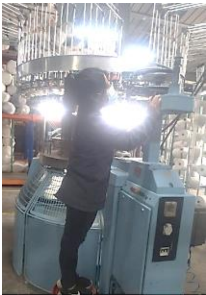
A. Verificación de la calibración de la circular.
