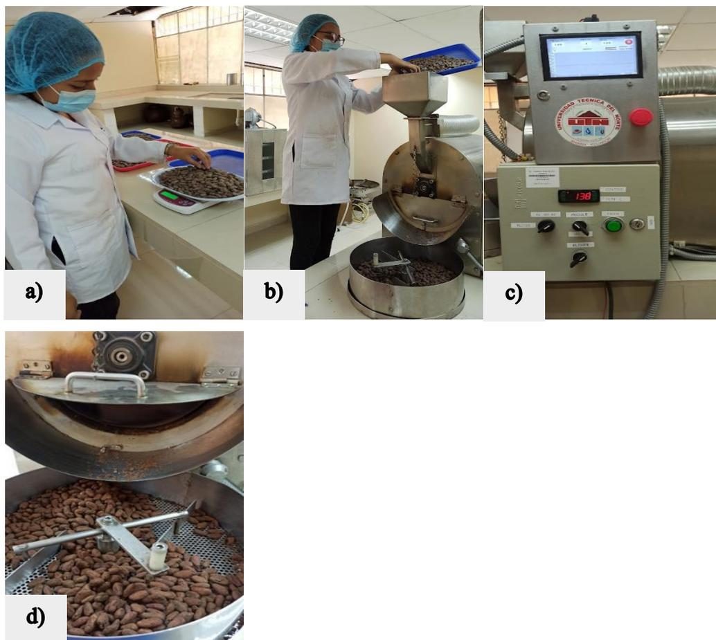
*Nota.* a) Pesado de Materia Prima. b) Alimentación del Tostador. c) Ajuste de parámetros. d) Descarga de granos tostados.
