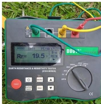
Figura 50. Medición con telurómetro
