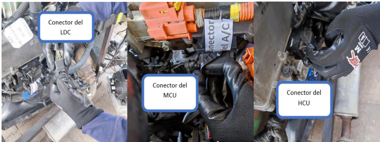
Anexo 5 figura 8 Conectores del LDC, MCU, HCU
