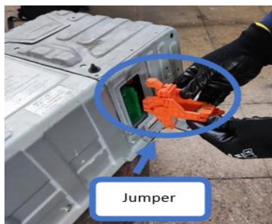
Figura 3.10 Desconexión del jumper
