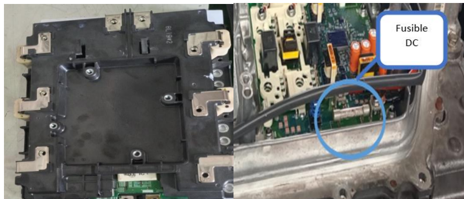
Anexo 5 figura 21 Modulo IPM Y fusible DC
