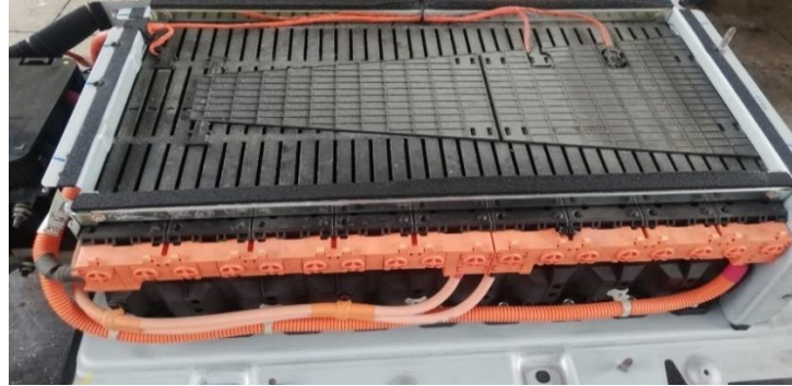
Figura 2.4 Batería de alta tensión del vehículo híbrido
