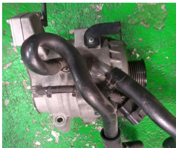
Figura 2.6 HSG (Generador de arranque híbrido)
