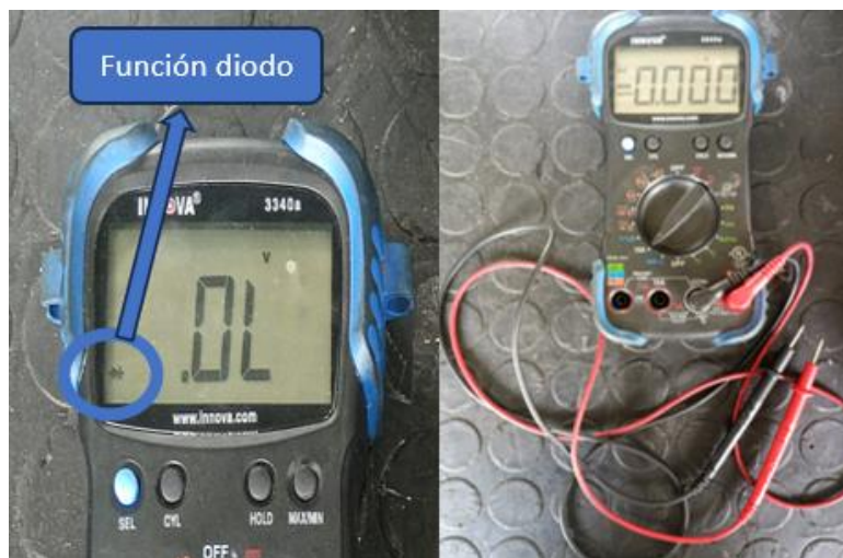
Figura 3.23 Multímetro en función diodo
