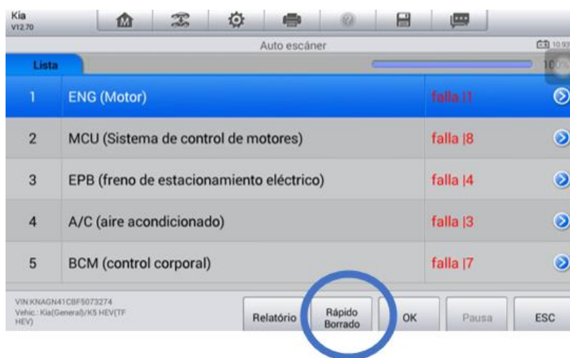
Figura 3.20 Función de eliminación de códigos de error
