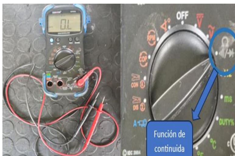
Figura 3.25 Multímetro función continuidad (INNOVA 3340a)
