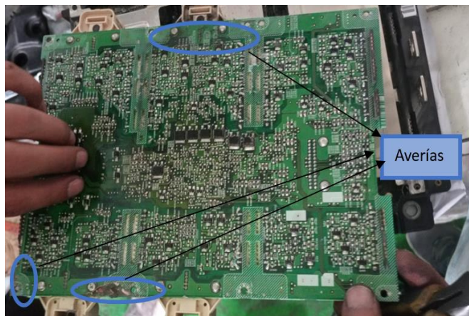
Figura 4.32 Averías causadas para el diagnóstico
