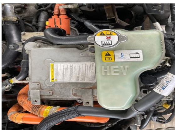
Figura 2.11 Inversor del vehículo híbrido
