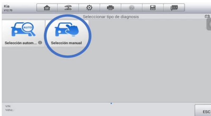
Figura 3.19 Obtención de DTC mediante selección manual
