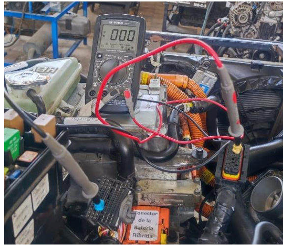
Figura 4.39 Comprobación del MCU
