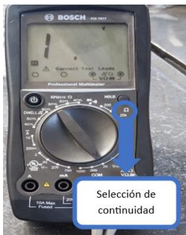
Figura 3.29 Multímetro función continuidad (Bosch FIX 76677)
