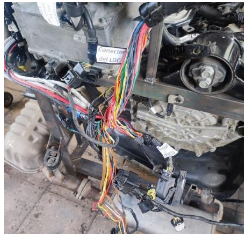
Figura 4.36 Cables del LDC
