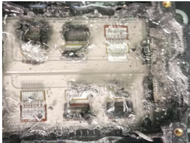
Figura 4.34 Sensor IGBT explotado
