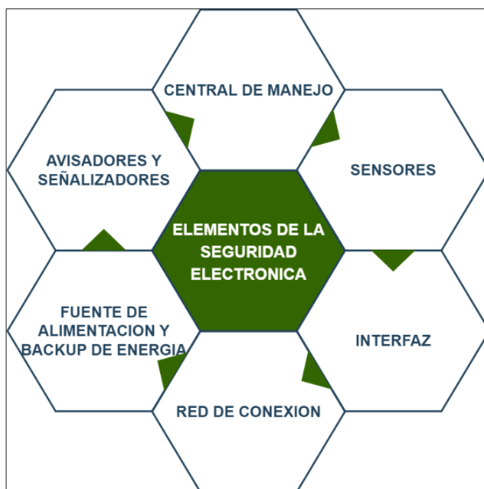
Figura 9. Elementos de la seguridad electrónica
