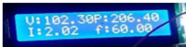
Fig.58: Registro de variables eléctricas de módulo PZEM 004t en pantalla LCD.
