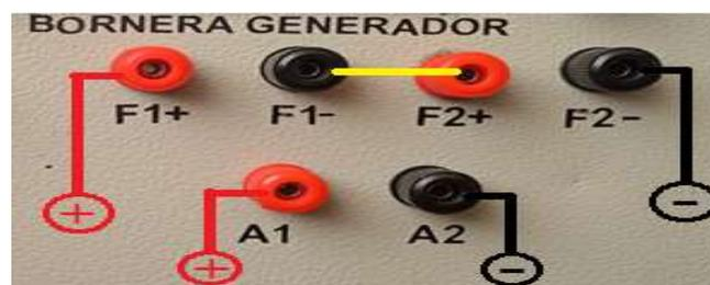
Fig. 10. Conexión del generador de excitación separada
