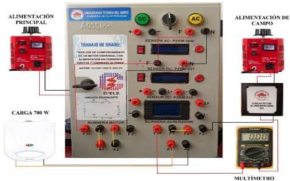
Fig.82: Conexión de elementos para la prueba de carga en AC.
