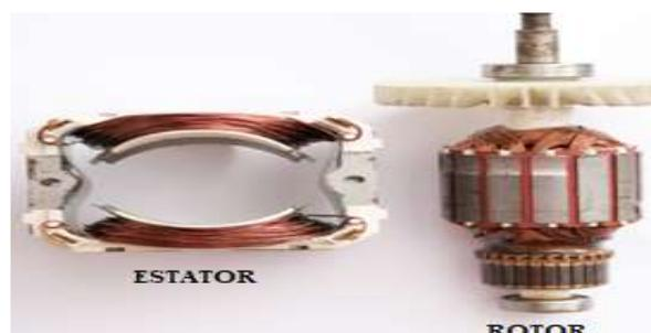
Fig.4. Devanados del estator y el rotor de un motor universal
