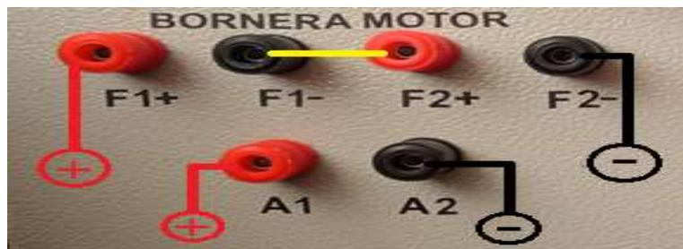
Fig. 9. Conexión del motor con terminales del rotor y estator independiente
