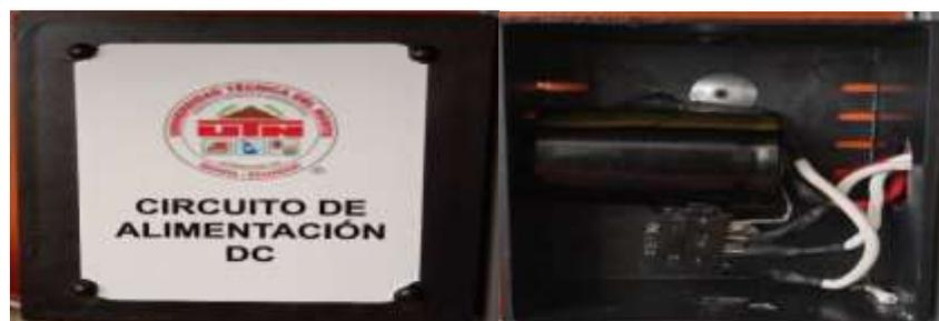
Fig.11. Circuito rectificador AC-DC del banco de pruebas
