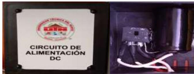
Fig.68: Unión de capacitor y rectificador para circuito DC.
