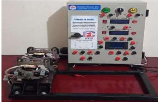
Fig.71: Banco de pruebas final para pruebas con motor universal.
