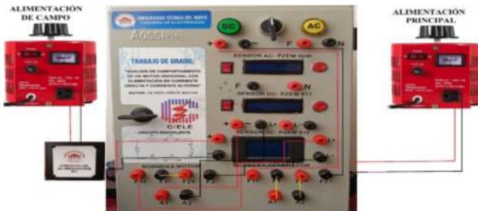
Fig.72: Conexión de componentes para prueba de circuito abierto CA.
