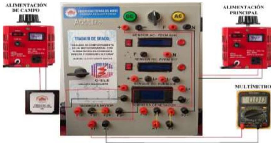
Fig.76: Conexión de componentes para prueba de cortocircuito CC.
