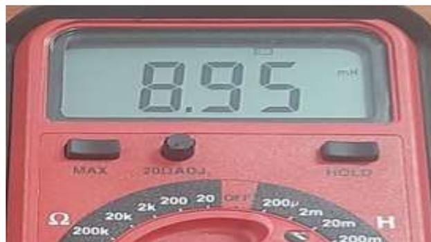
Fig. 31: Mediciones de prueba DC de la inductancia del motor universal.
