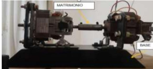
Fig.67: Matrimonio implementado para pruebas con carga.
