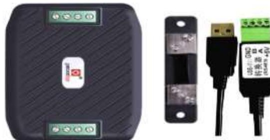
Fig. 25: Módulo de medición DC PZEM – 017.
