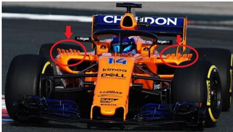
Figura 1.14 Elementos aerodinámicos que generan vórtices. Tomado de (Caro, 2022).
