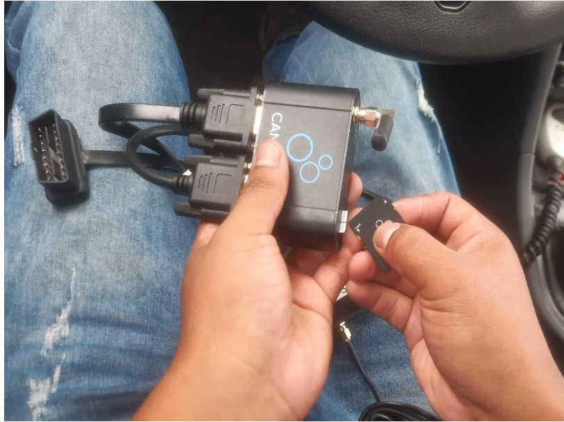
Anexo 1. Instalación del equipo Datalogger en la entrada OBDII
