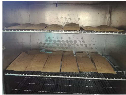
Foto 7. Colocación de las muestras en las estufa
