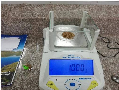
Foto 6. Peso de la muestra de contenido de humedad
