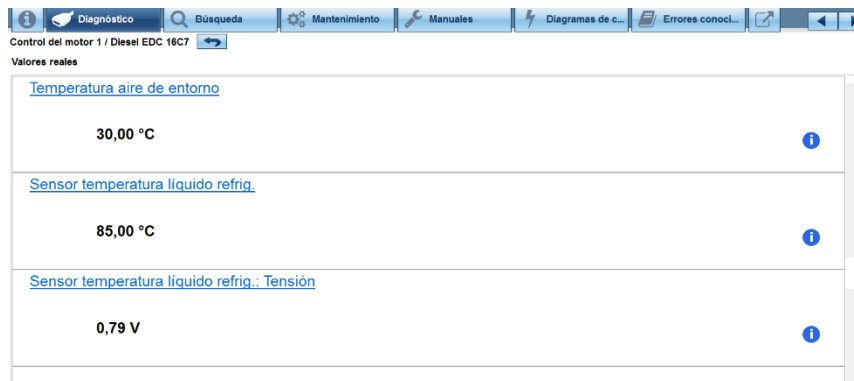
Figura 21 Puesta a temperatura de trabajo del motor
