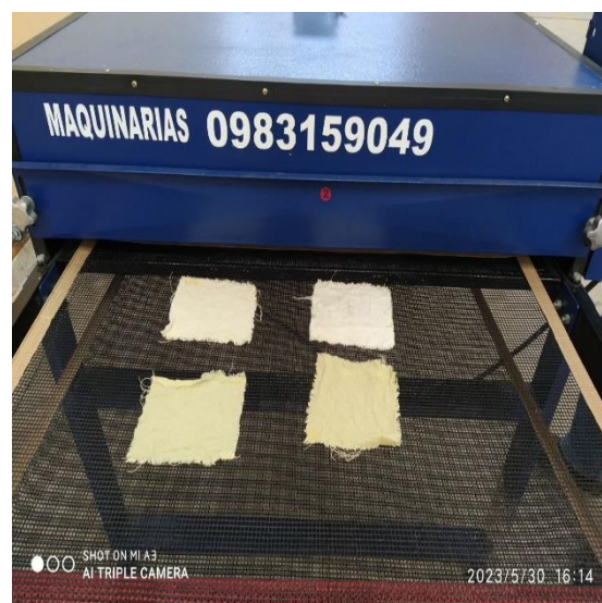
Secado de muestras al 2.5% de fijador
