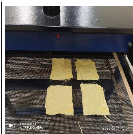
Secado de muestras al 5% de fijador
