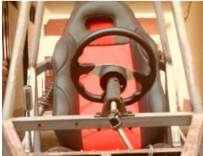
Figura 2.21 Volante instalado en la base
