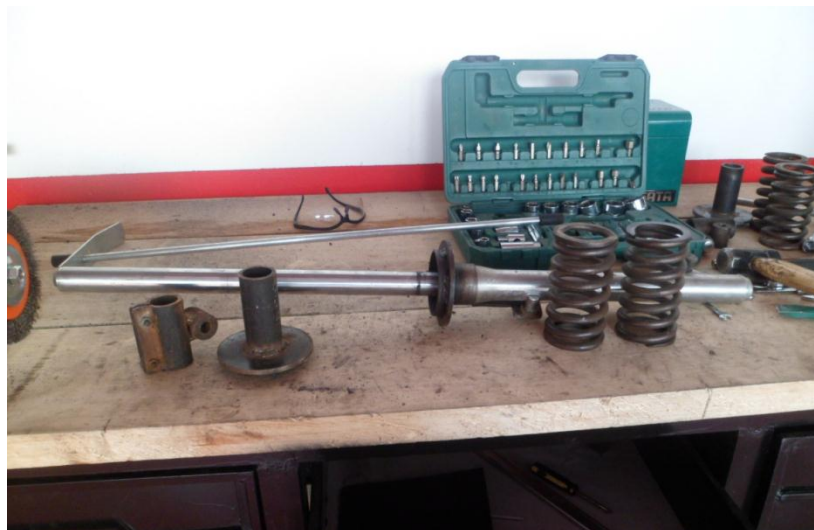
Figura 2.16 Componentes del Amortiguador trasero
