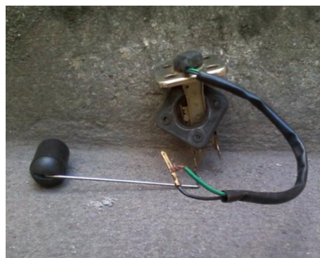
Figura 1.44 Unidad electrónica con flotador de combustible
