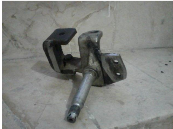
Figura 2.20 Punta de eje instalada la base para los terminales de los axiales de la dirección
