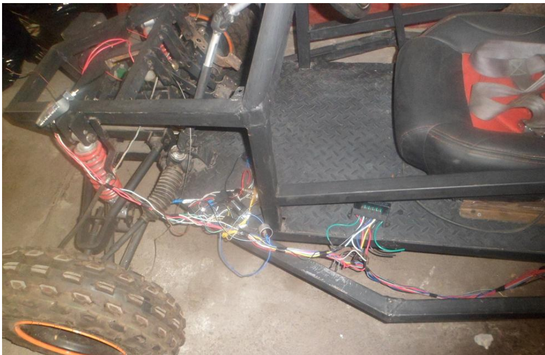
Figura 12 Adaptación de sistema eléctrico
