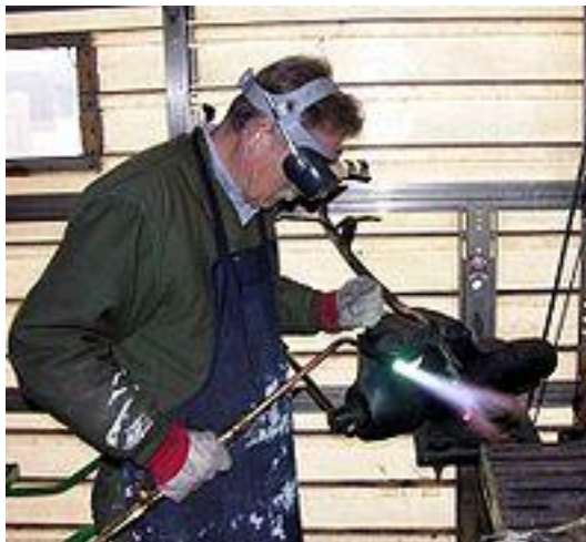
Figura 1.52 Soldadura a gas
