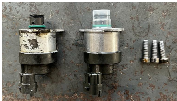
Figura 2.6 Derecha ZME mal estado, izquierda ZME nueva
