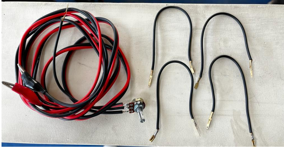
Figura 2.2. Dispositivo variador de voltaje para el sensor MAF
