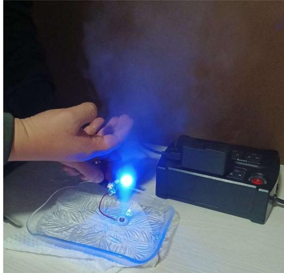
*Nota:* La fotografía muestra el funcionamiento del nebulizador ultrasónico con una bandeja de agua. Fuente: (Autoría propia)
