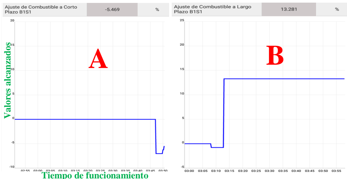
Figura 3.7. Comportamiento del SFT y LFT con desconexión del sensor MAP.
