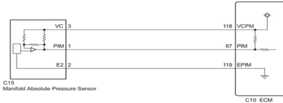
Figura A 30. Diagrama eléctrico Sensor MAP.
