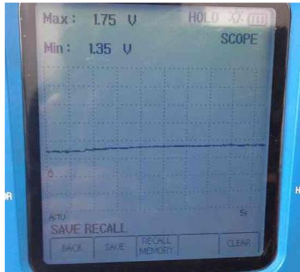
Figura A 39. Gráfica de funcionamiento del sensor ECT.
