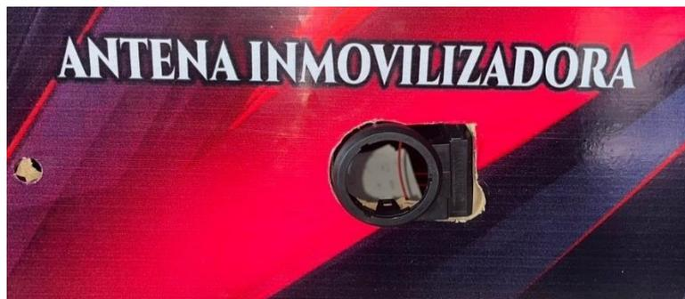
*Figura 16. Antena Inmovilizadora y chip Ford Explorer 2013*
