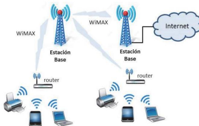
*Nota.* Composición de una serie de redes WLAN que conforman una red WMAX, para la comunicación de datos entre estos, obtenido de Salazar, J. (s.f.).
