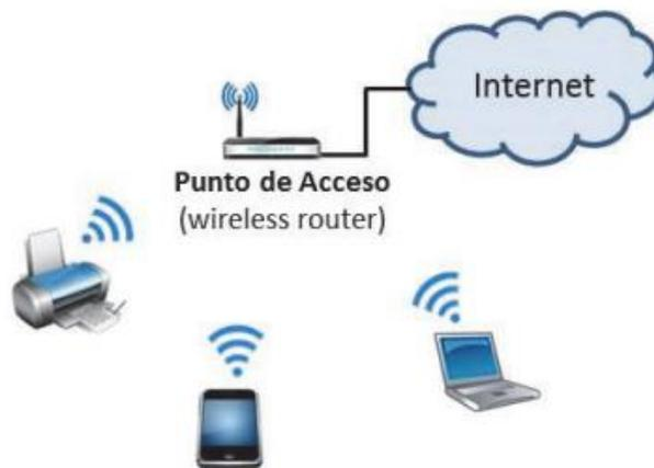
*Nota.* Visualización de la red inalámbrica WLAN con la conexión a los diferentes dispositivos a través de una red Wifi, obtenido de Salazar, J. (s.f.).
