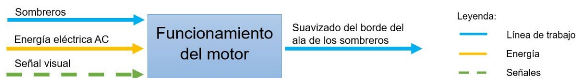
Figura 2.6: Diagrama funcional de nivel cero del motor
