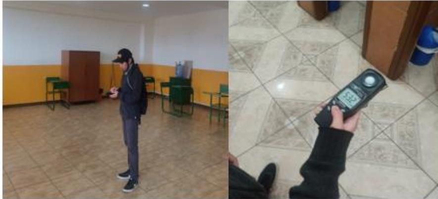
Fig. 2.18 Toma de datos de los baños de estudiantes con el luxómetro
