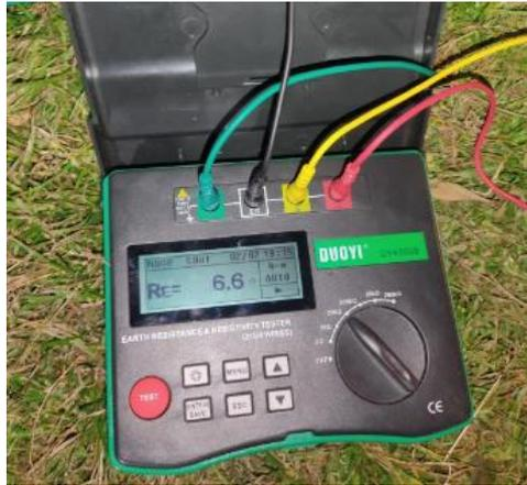
Fig. 3.6 Medición de la resistencia del suelo
