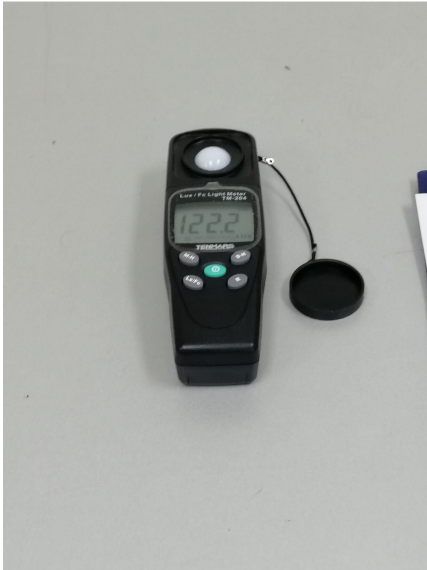
Anexo 1 Toma de medidas con luxómetro planta baja
