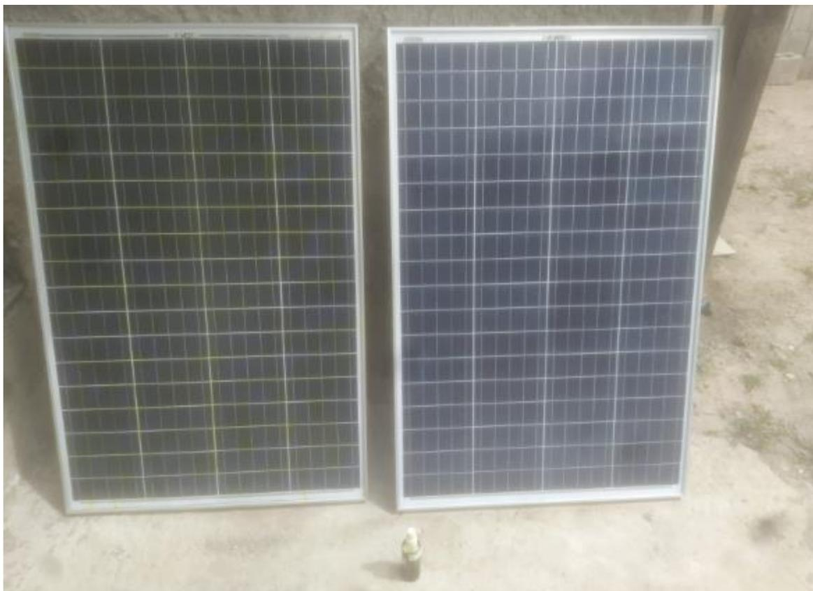
*Ilustración 5 panel de la izquierda con recubrimiento hidrofóbico y panel de la derecha con nanorecubrimiento para el polvo*
