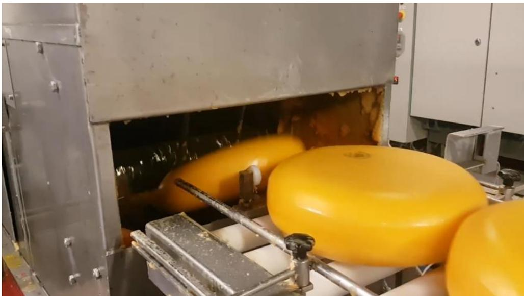
*Figura 1.4 Máquina enceradora con depósito y baño de cera [29].*
