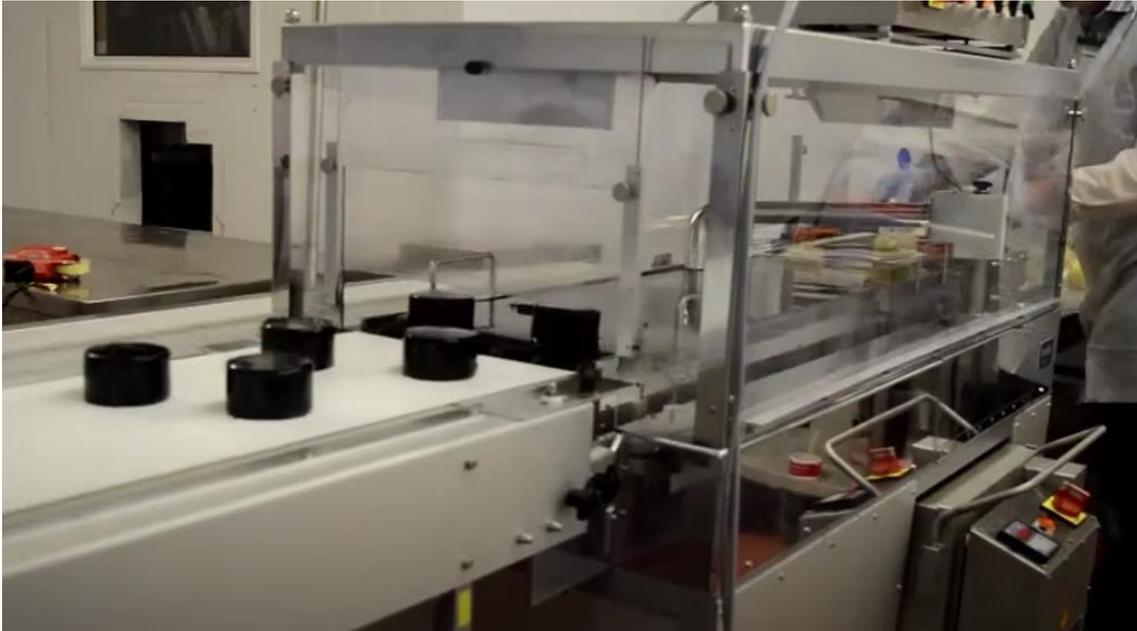
*Figura 1.3 Máquina enceradora de queso con banda transportadora.*
