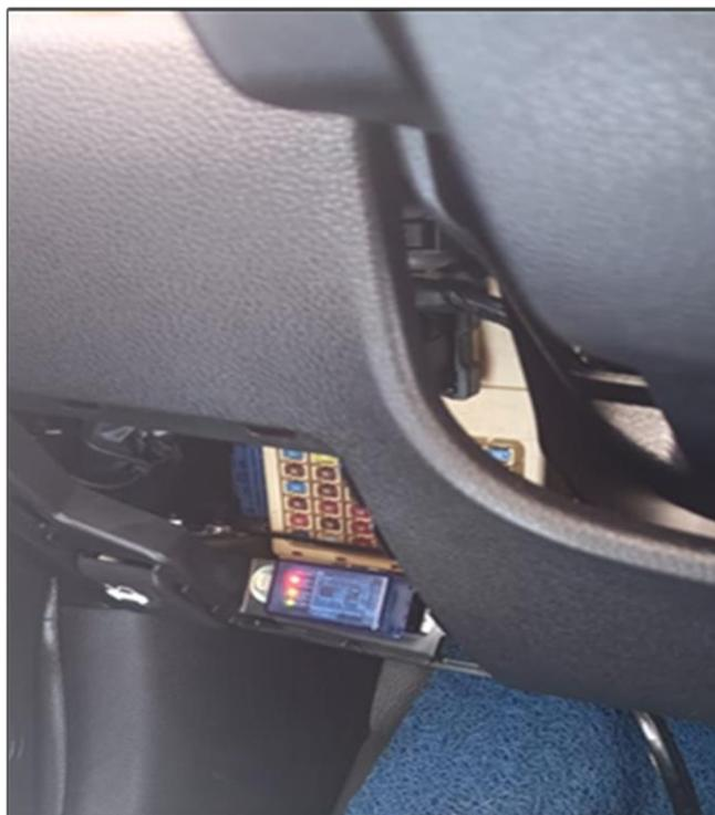
**Figura 3.11** Conexión del dispositivo ELM327
