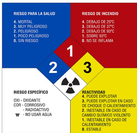
Figura 8. Diamante de materiales peligrosos NFPA 704
