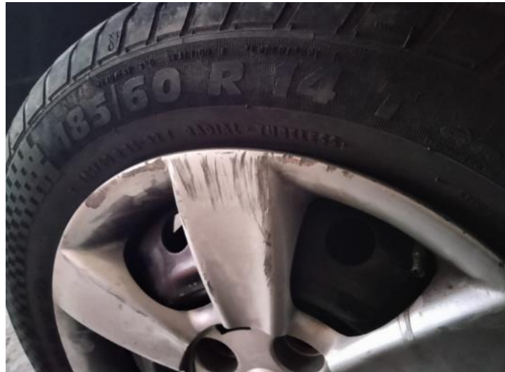
Figura 2.9 Dimensión de Neumáticos Utilizados en las Pruebas de Freno
