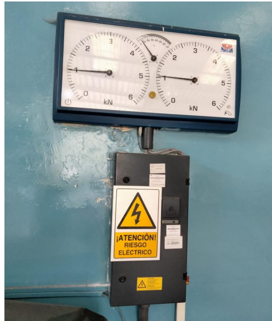
Figura AII.1. Medición de Eficiencia para pastillas Semi-Metálicas
