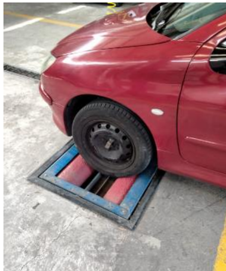
Figura 2.13 Posicionamiento del vehículo Peugeot 206 en el banco de pruebas
