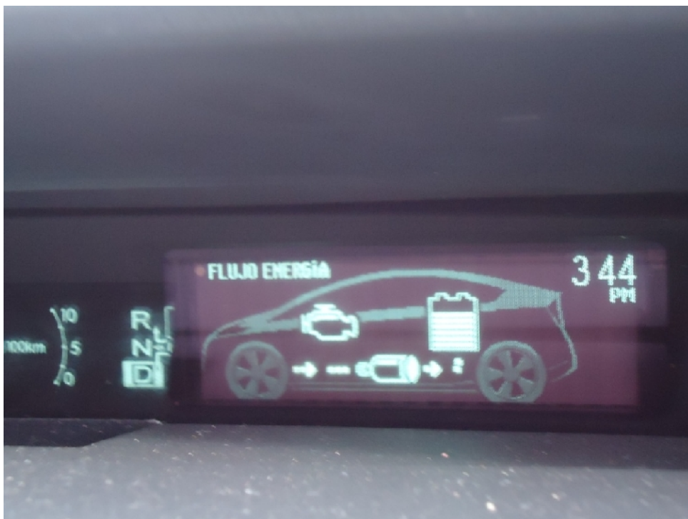
Fig. 27. Toyota Prius en freno regenerativo (posición D )
