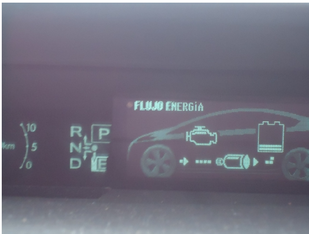
Fig. 28. Toyota Prius en freno regenerativo (posición B )
