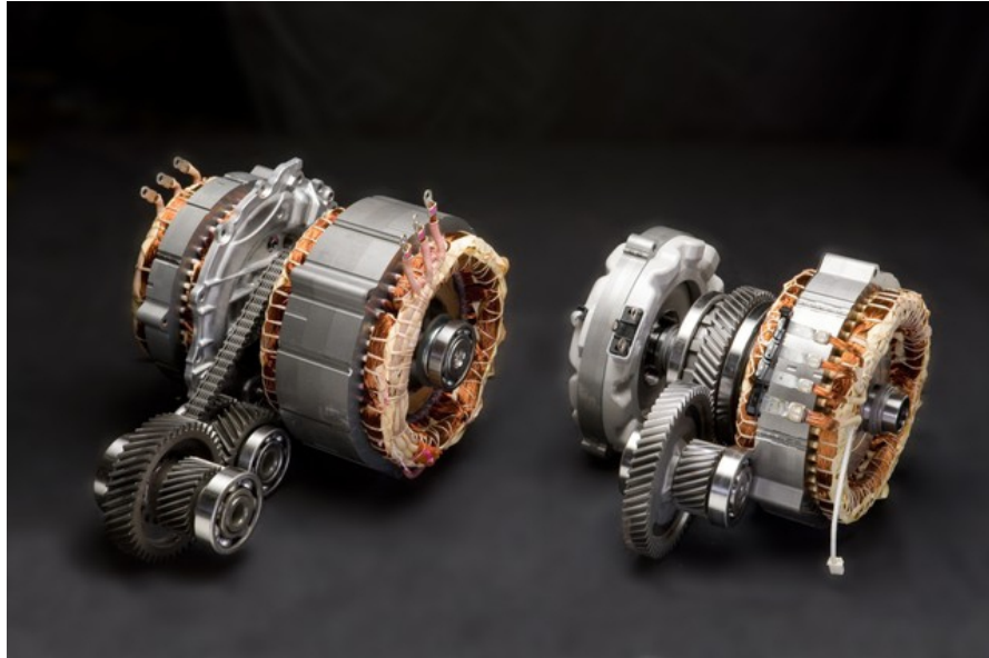
Fig. 2 Motores MG1 y MG2 de cadena y engranajes
