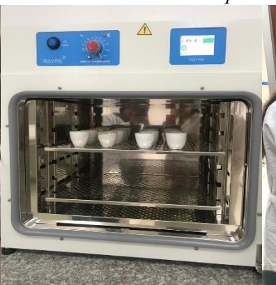
Secado en estufa de las muestras
