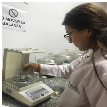
Pesado de los crisoles vacíos
