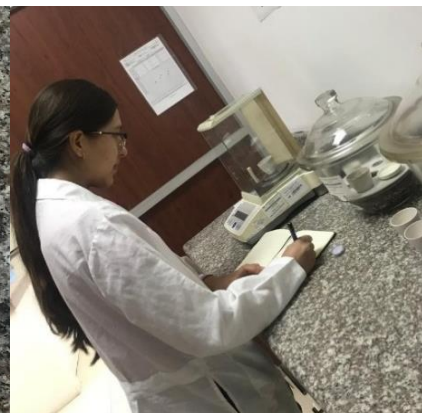
Pesado de los crisoles calcinados
