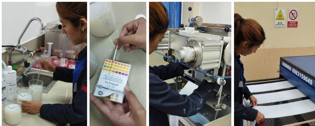
*Nota:* De izquierda a derecha se muestra cada paso requerido en el proceso de impregnación de los tejidos: soluciones a distintas concentraciones, control del pH, uso del foulard para impregnación y secado de las muestras mediante el túnel de secado. Fuente: Propia
