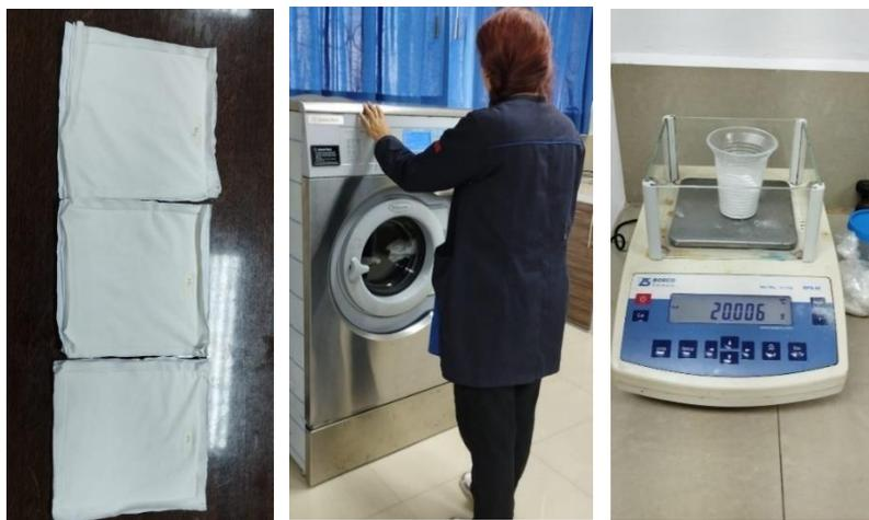
**Figura 16***Método de prueba AATCC 22 después del lavado*
