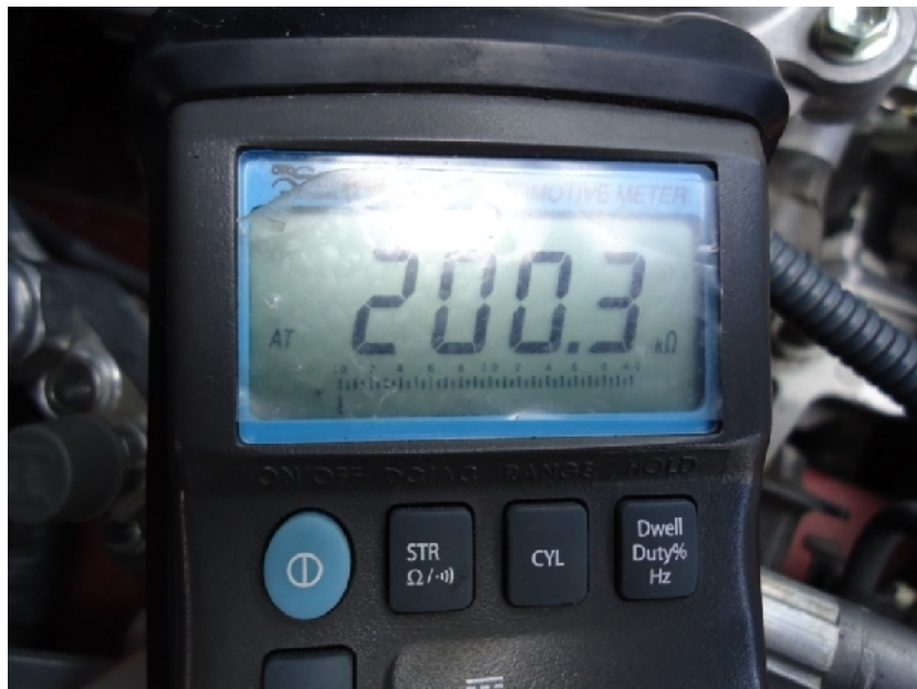
Fig. 77. Resistencia Medida: 200,3 K
