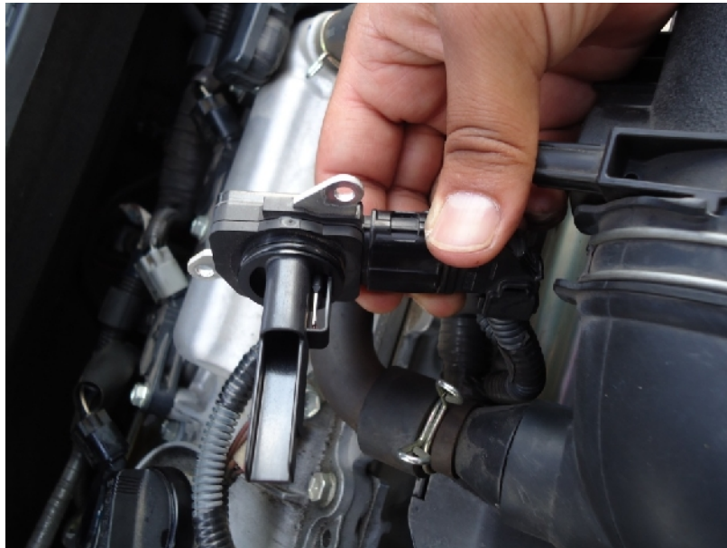
Fig. 100. Sensor MAF, en el cual se ubica el sensor IAT
