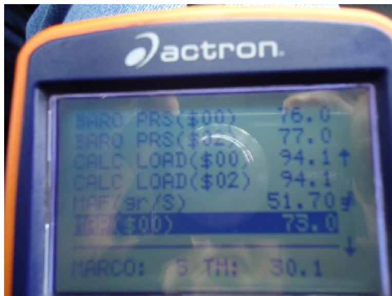
Fig. 83. Grafica con Valores de una aceleración fuerte
