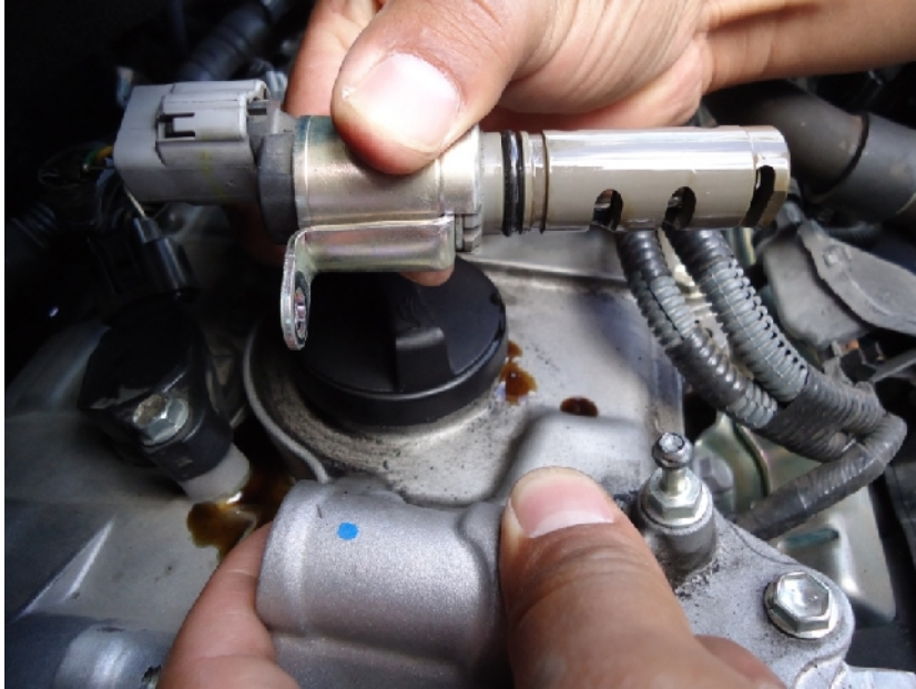
Fig. 42. Resistencia medida: 7,9 (19 °C)
