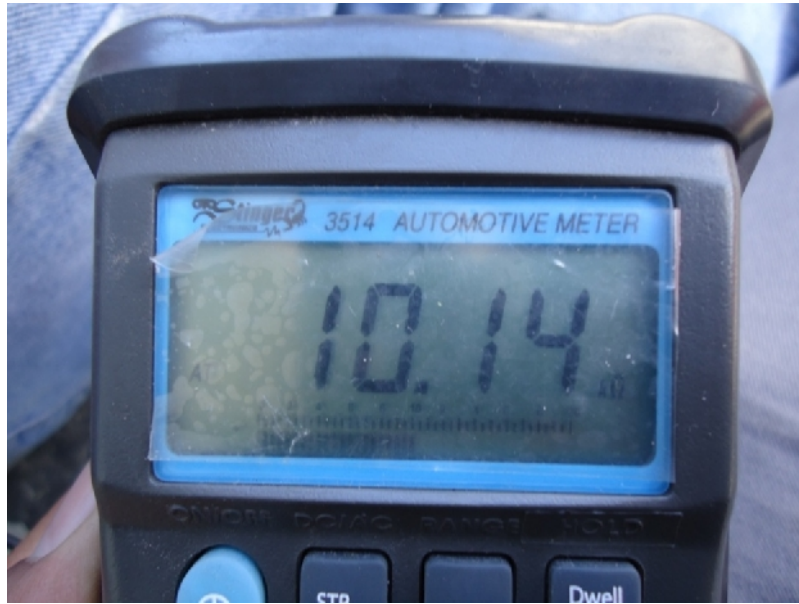
Fig. 95. Resistencia Medida: 10,14 K
