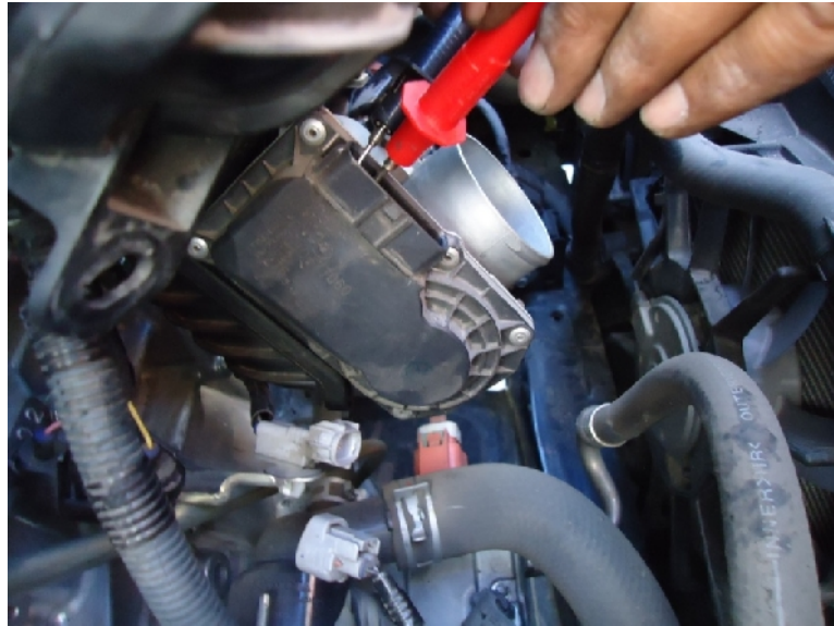
Fig. 46. Comprobando la resistencia del Cuerpo de Aceleración.
