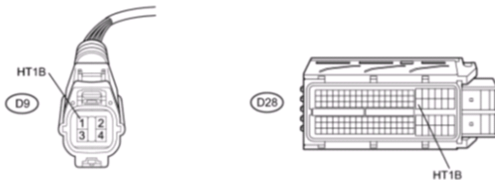
Fig. 69. Socket del sensor y del ECM
