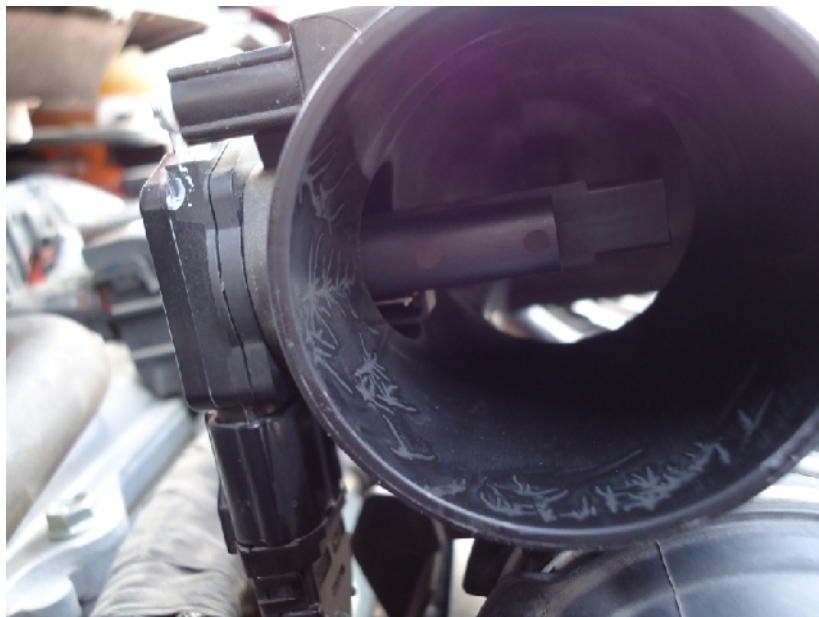
Fig. 86. Vista del Sensor MAF dentro del Múltiple de Admisión
