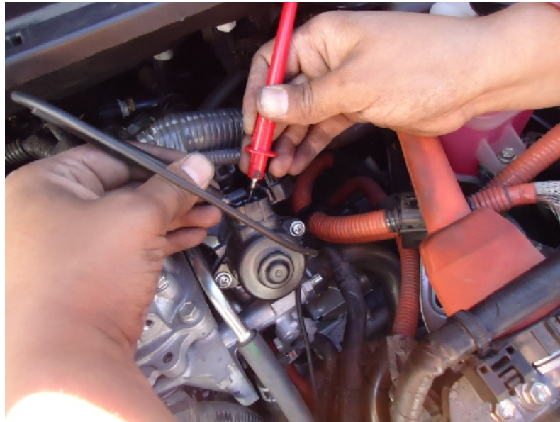
Fig. 111. Midiendo Resistencia Válvula EGR.
