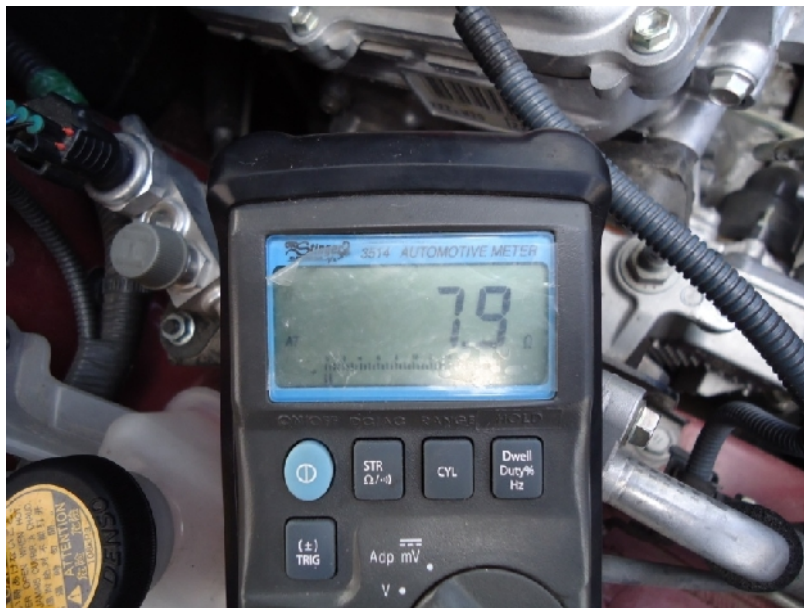
Fig. 42. Resistencia medida: 7,9 (19 °C)
