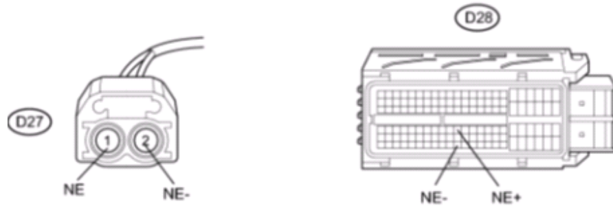
Fig. 63. Socket del sensor y del ECM
