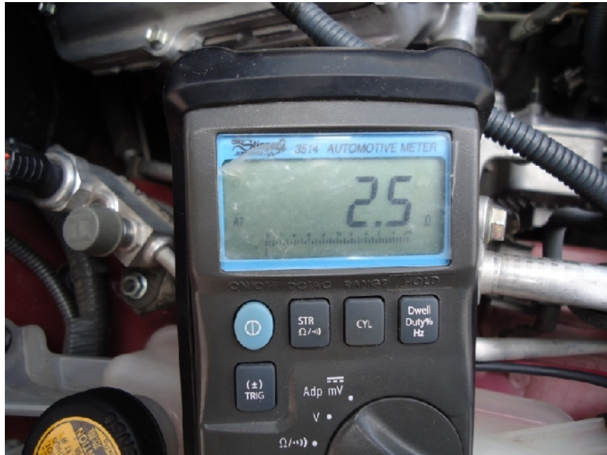
Fig. 56. Resistencia Medida: 2,5 (19 °C)
