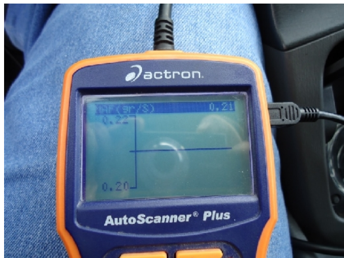
Fig. 81. Valores del Sensor MAF con el vehículo detenido con carga suficiente
