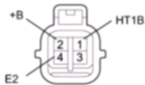
Fig. 68. Socket del Sensor.
