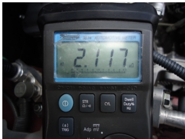
Fig. 67. Resistencia Medida: 2,117 K
