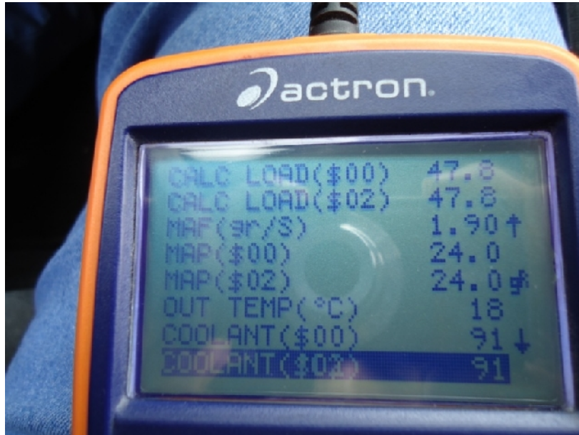
Fig. 51. Toma de medidas en MODO MANTENIMIENTO
