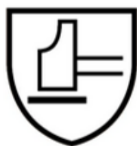
Fig. 13 Notación del guante de seguridad según EN 388
